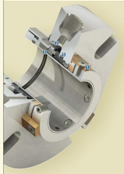
Si installa facilmente ed in modo accurato I dispositivi di centraggio multi-direzionali automaticamente posizionano la tenuta e caricano le molle in modo uniforme.
